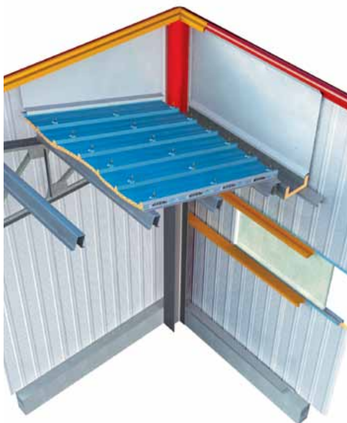
RACCORDO COPERTURA, PARETE, GRONDA (vista dall'alto)
