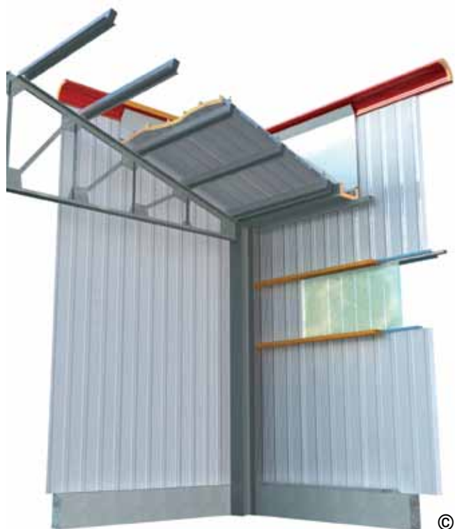
RACCORDO COPERTURA, PARETE, GRONDA (vista dal basso)
